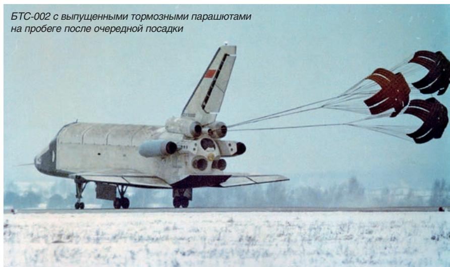
*БТС-002 с выпущенными тормозными парашютами на пробеге после очередной посадки*
