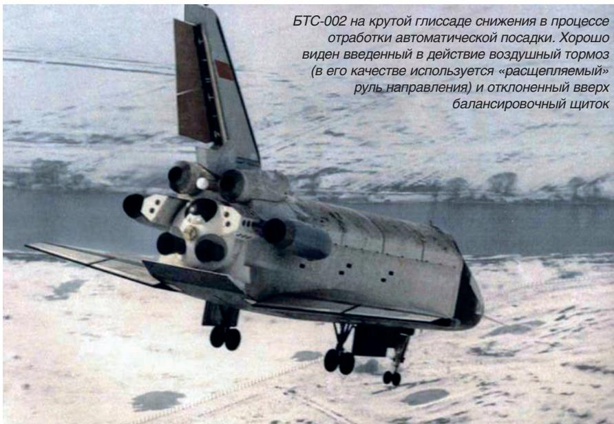
*БТС-002 на крутой глиссаде снижения в процессе отработки автоматической посадки. Хорошо виден введенный в действие воздушный тормоз (в его качестве используется «расщепляемый» руль направления) и отклоненный вверх балансировочный щиток*
