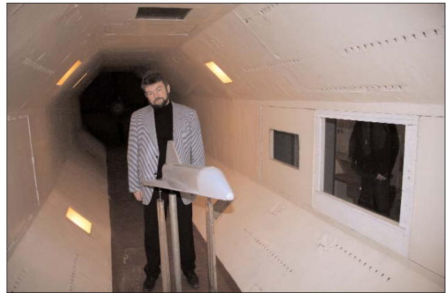
▲ Автор в рабочей части аэродинамической трубы Т-1. Справа – окно для наблюдения за аэродинамической моделью во время исследований. Весна 2007 г.
